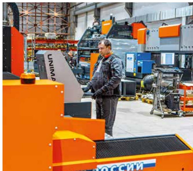
Важно, чтобы пользовательский интерфейс станка был дружелюбен оператору. Основные органы управления сосредоточены на стойке в лицевой части. Ведь каждый элемент управления, размещенный вне стойки, снижает производительность труда оператора.
