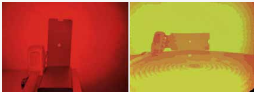
Рис. 14. Сравнение наблюдения модельной скрытой камеры датчиком К-18 (фотография слева) и ToF камерой (фотография справа) на расстоянии 45 см
