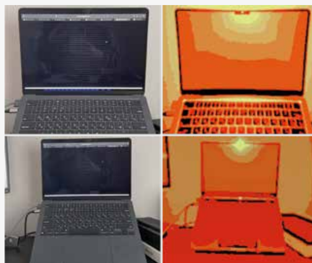
Рис. 7. Фотография видеокамеры ноутбука в обычном изображении (слева) и полученном с помощью датчика глубины (справа) на разных расстояниях
