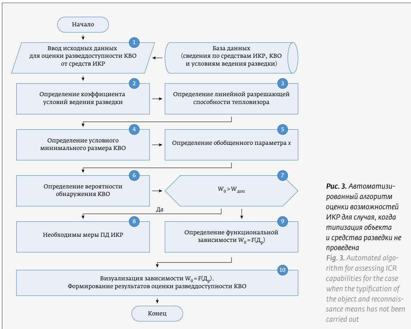
**Рис. 3.** Автоматизированный алгоритм оценки возможностей ИКР для случая, когда типизация объекта и средства разведки не проведена
