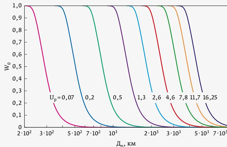
**Рис. 5. Зависимость вероятности обнаружения от дальности при различных значениях коэффициента условий ведения разведки**
